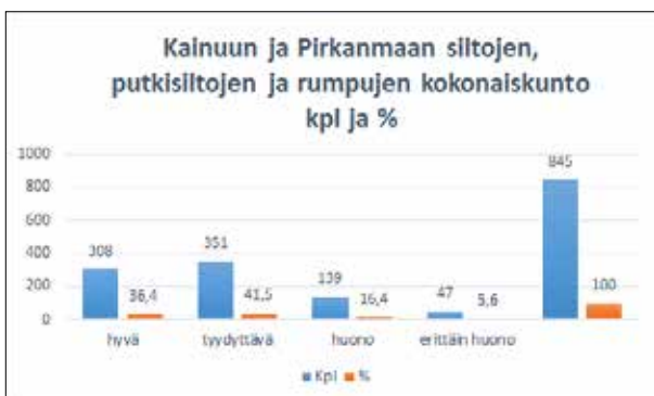
Kainuun ja Pirkanmaan siltojen, putkisiltojen ja rumpujen kokonaiskunto kpl ja %.
