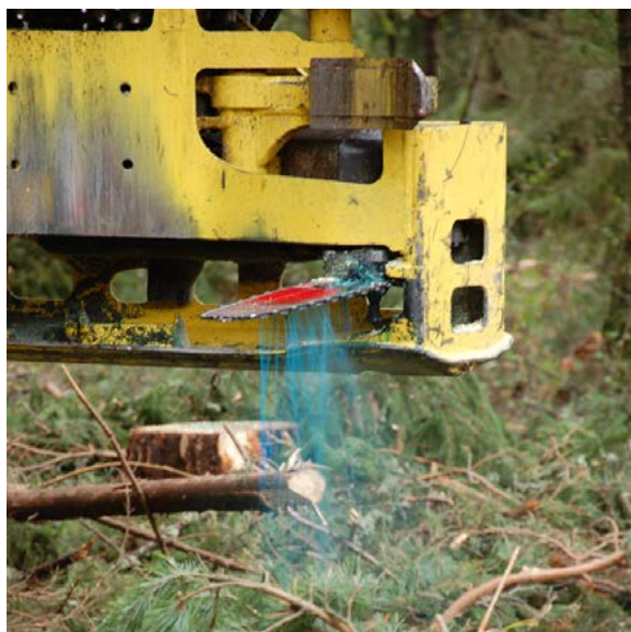
Bild 19. Det är viktigt att stubbehandlingsaggregatet fungerar felfritt för att stubbehandling ska lyckas bra. Färgmedlet gör det möjligt att följa upp täckningen på stubbytan. Bild Johanna Kleemola, Skogscentralen.
